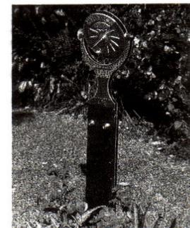
6 Äquatorial-Sonnenuhr mit sehr präziser Zifferblatteinteilung der »wahren« und »mittleren« Sonnenzeit sowie Zeitgleichungswerte des Ortszeit- und Normalzeitmeridians. In horizontaler Ebene eine mechanisch bedienbare Weltzeituhr. Durchmesser 80 cm; Material Marmor, Stahl, Kupfer und Messing; an den Kegelachsen drehbar, hergestellt 1989.
