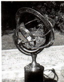
2 Äquatorial-Sonnenuhr zur Ermittlung der »wahren« und »mittleren« Sonnenzeit des Standortes. Zeitgleichungskurven um der 11., 12. und 13. Stunde, Angaben der Tag- und Nachtgleichen, Winter- und Sommersonnenwende sowie Weltzeituhr-Zifferblatt. Durchmesser 65 cm; Material Kupfer und Messing, hergestellt 1985.
